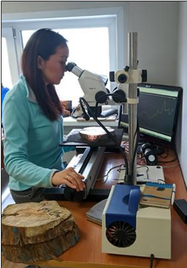
Gulzar Omurova im Jahr 2019 bei der Messung von Jahrringlängen einer Stammscheibe am LINTAB™ in der Siberian Federal University in Krasnoyarsk; bei den Bohrkernen kommt das CooRecorder-Programm zum Einsatz (Foto: Gulzar Omurova)
