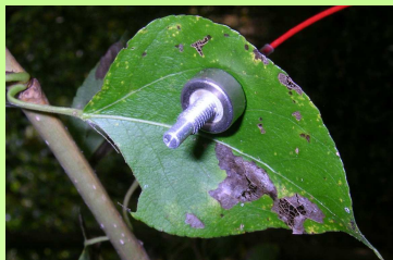
Abb. 4: ZIM-Magnetsonde zur Blattpotentialmessung (Turgormessung) an einem Pappelblatt
