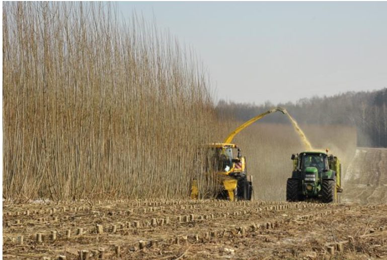
Ernte mit Feldhäcksler mit Holzertevorsatz
