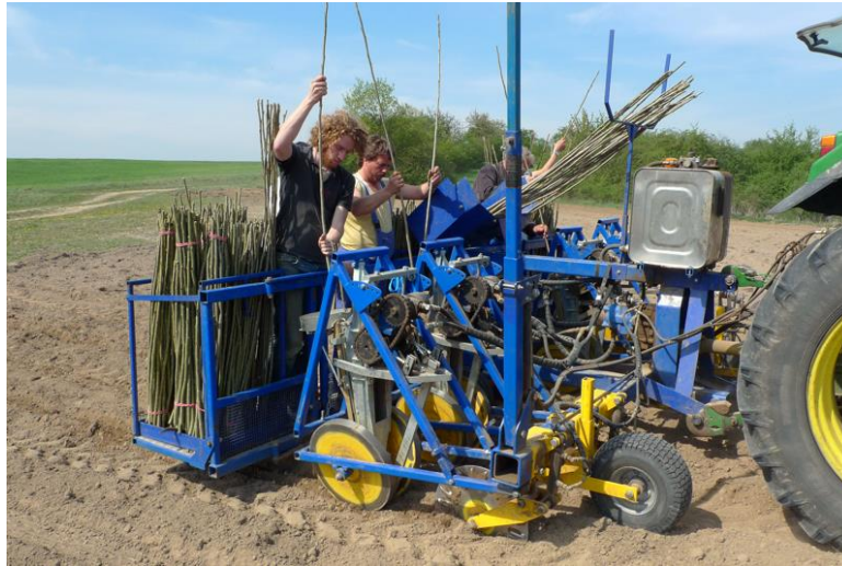
Spezielle Pflanztechnik, z.B. Step-Planter
