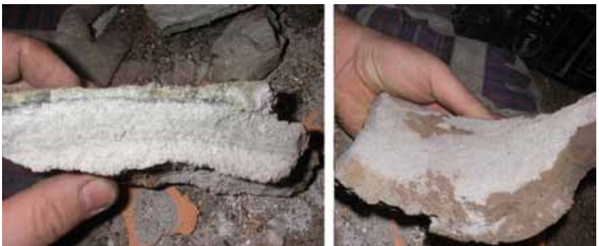
Abb. 7: Verbackungen nach Entfernung aus der Wirbelschicht
