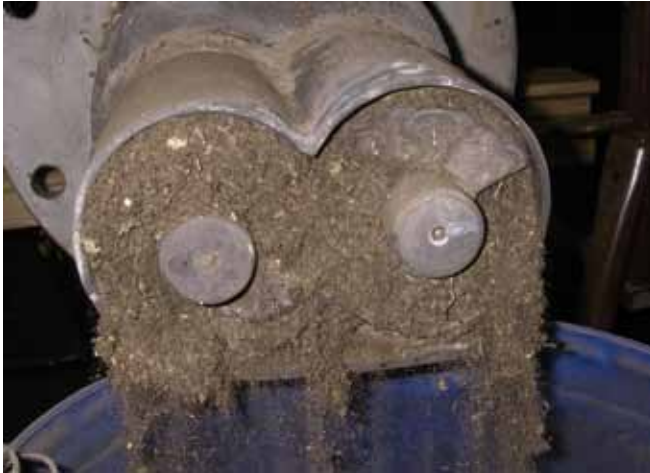
Abb. 6: Eintragschnecke beim Aufnehmen der Schneckenkennlinie
