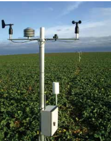
Vier Klimamessstationen wurden in Abständen von 5, 20, 50 und 100 m auf dem Ackerschlag auf der windabgewandten Seite von Transekt 2, östlich des Gehölzstreifens installiert. Windgeschwindigkeit und -richtung wurden an jeder Station erfasst, die Niederschlagsmenge und die Globalstrahlung nur an der Station in 20 m Entfernung zum Gehölzstreifen (s. Abbildung 3).
