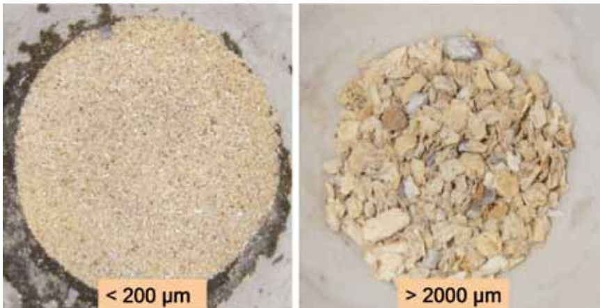
Abb. 1: Glührückstände aufbereiteter Strandalgen
